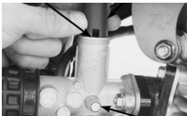
PARAFUSO DE ACELERAÇÃO
