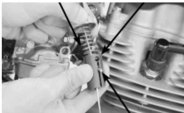
RECORTE CABO DO ACELERADOR VÁLVULA DE ACELERAÇÃO
