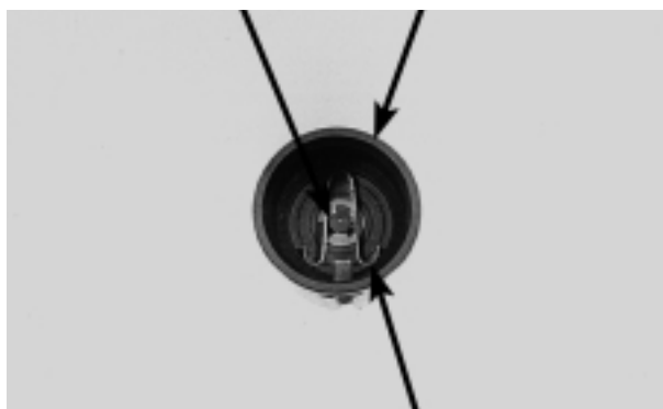
TRAVA DA AGULHA MOLA VÁLVULA DE ACELERAÇÃO
