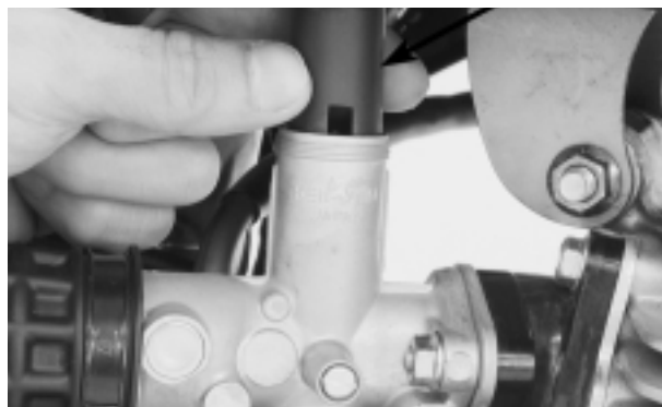
VÁLVULA DE ACELERAÇÃO
