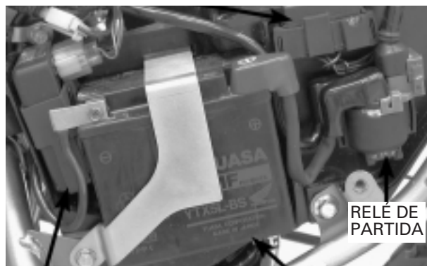
MÓDULO DE CONTROLE DE IGNIÇÃO (ICM)
