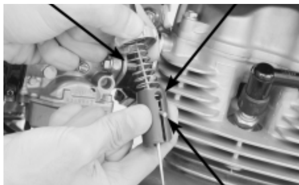
CABO DO ACELERADOR
