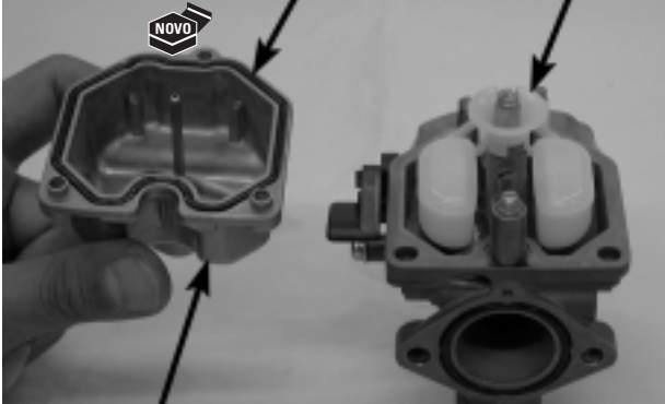
CUBA DA BÓIA PARAFUSOS CUBA DA BÓIA
